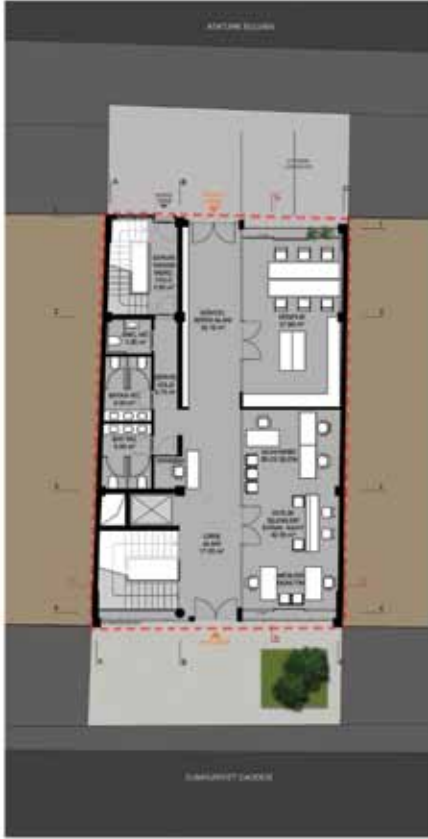
ZEMİN KAT PLANI ÖLÇEK: 1/100 TOPLAM ALAN: 313,00 m 2 TOPLAM İNŞAAT KAT ALANI: 210 m 2
